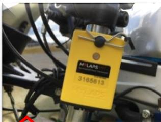
◇ベースホルダーにランスポンダーを付け、Rピンを必ず刺す。ピンの先端にタイラップで固定すると尚良い
